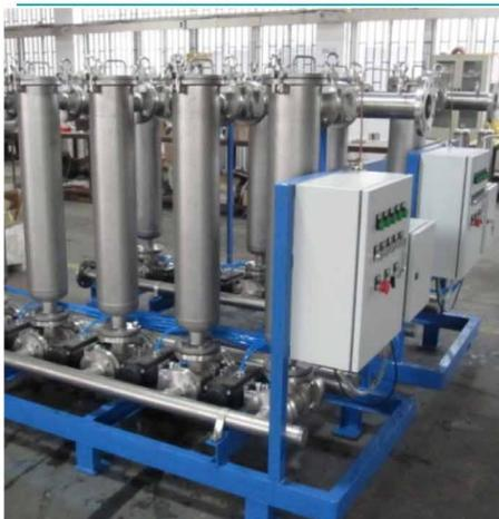
本过滤器产品是采用多个标准过滤单元集成的全自动过滤系统，根据过滤流量大小及杂质含量多少，可增减过滤单元数量，以满足最佳工况需求。适用于低粘性液体的过滤，如原水、污水、溶剂、汽油、重型焦化汽油、柴油、渣油等液体。
