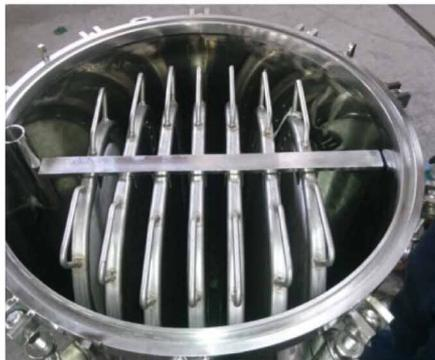
南京博滤工业 BVF 系列叶片式过滤器，采用振动排渣立式设计，单机内部集成多块过滤板，过滤板由多层不锈钢滤网组成，安装于筒体内集液管上，当过滤时间或压差达到设定值时，排空液体后，振动排渣器将滤网上的滤饼振除，使滤网再生。
